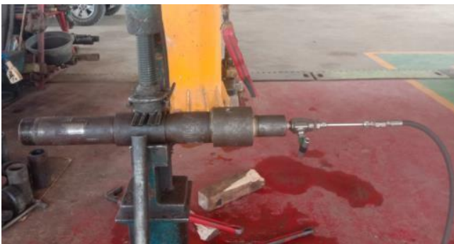
Figure 1.6 Pressure test modifikasi plug di surface
