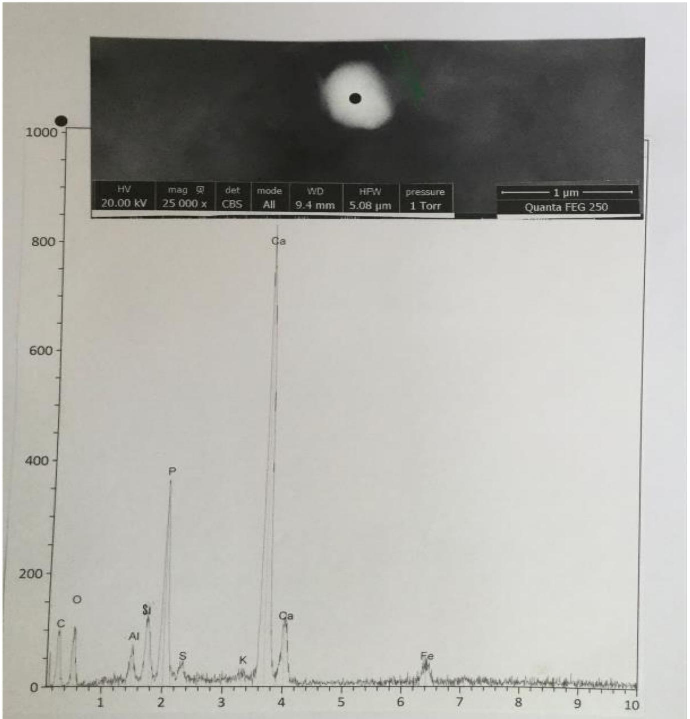
**Fig. 17** : Micro-marbles of iron oxide. *Above* : SEM photograph (in CBS, 10000x) of the micro-marbles. *Below* : spectrum at the black point. C : carbon ; O : oxygen ; Fe (three peaks) : iron ; Na : sodium ; Mg : magnesium ; Al : aluminium ; Si : silicium ; P : phosphorous ; S : sulphur ; K : potassium ; Ca (two peaks) : calcium. Zn : zinc.
