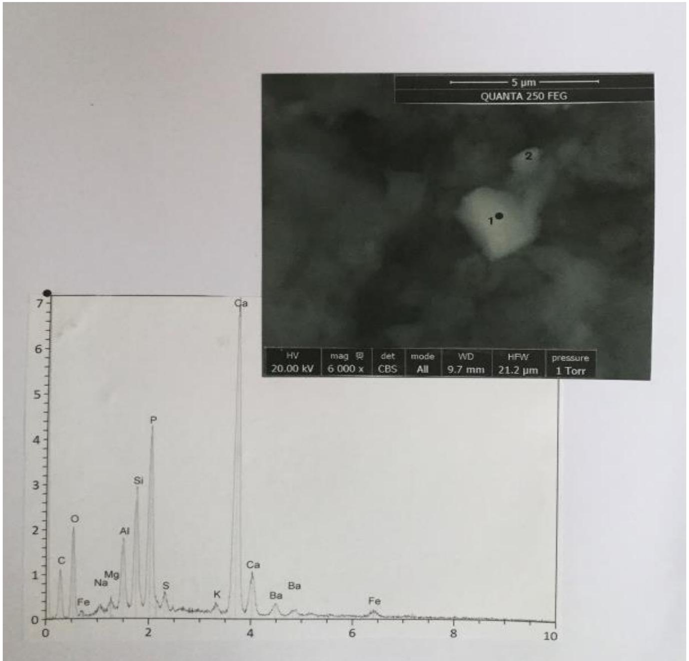
**Fig. 13** : A third example of barytine particle. *Above* : SEM photograph (in CBS, 12 000x) of the particle. *Below* : spectrum at the black point. C : carbon ; O : oxygen ; Fe (three peaks) : iron ; Na : sodium ; Mg : magnesium ; Al : aluminium ; Si : silicium ; P : phosphorous ; S : sulphur ; K : potassium ; Ca (two peaks) : calcium ; Ba (two peaks) : barium.
