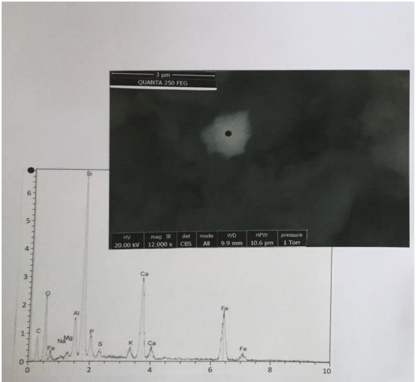
**Fig. 16** : The O<sub>2</sub> particle. *Above* : SEM photograph (in CBS, 25000x) of the particle. *Below* : spectrum at the black point. C : carbon ; O : oxygen ; Al : aluminium ; Si : silicium ; P : phosphorous ; S : sulphur ; K : potassium ; Ca (two peaks) : calcium ; Fe : iron.
