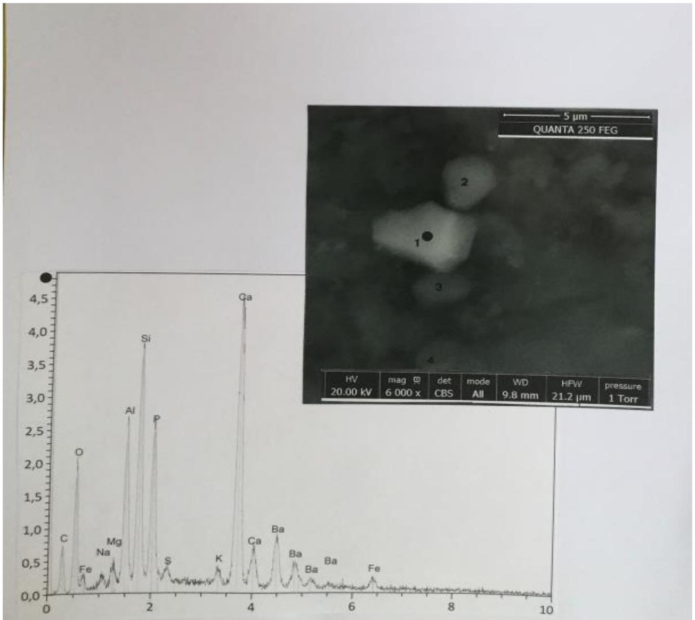
**Fig. 15** : The O1 particle. *Above* : SEM photograph (in CBS, 12000x) of the particle *Below* : spectrum at the black point. C : carbon ; O : oxygen ; Fe (three peaks) : iron ; Na : sodium ; Mg : magnesium ; Al : aluminium ; Si : silicium ; P : phosphorous ; S : sulphur ; K : potassium ; Ca (two peaks) : calcium.
