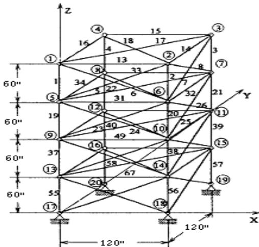
Fig. 3. The 72-Bar Truss
