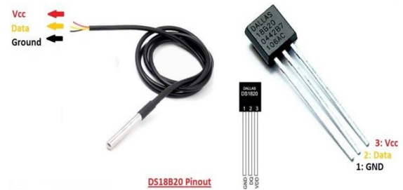
Fig. 3. DS18B20 pin-out
