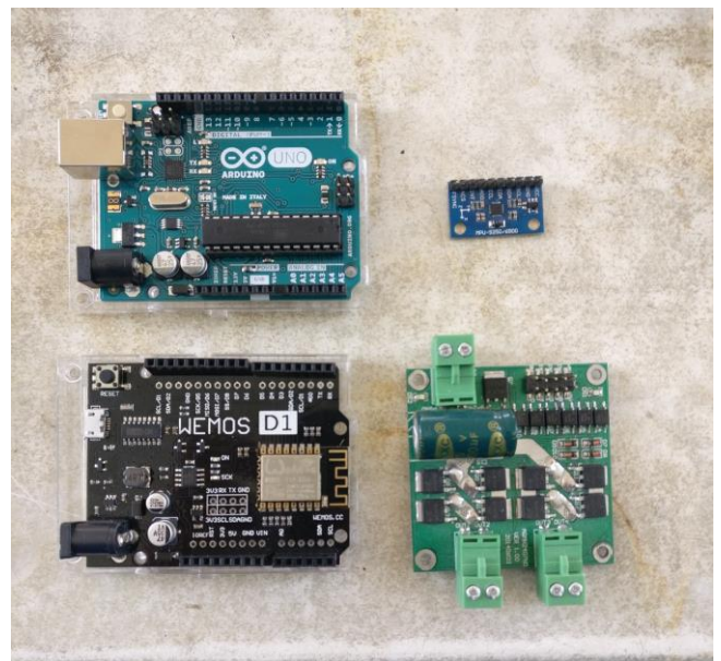
Fig. 5. Arduino Uno, MPU-9250, Wemos D1 R2, 7A Dual Motor Driver
