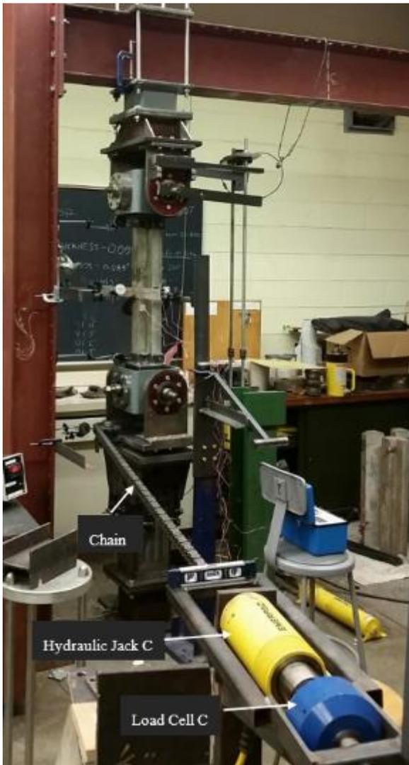
Fig. 7. Torsion test setup
